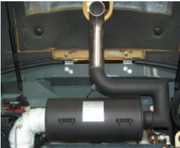
Das Abgasgedruckerohr wird bereits durch GfA in das Filtereintragsrohr gelötet.
