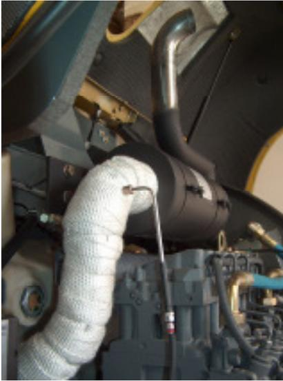
Das GfA-DPF/KAT-System wird anstelle des Originalschalldämpfers eingebaut. Der Filter wird mit einer beigeestellten Halterung befestigt. Für die Befestigung werden die gleichen Haltepunkte wie auch beim Original-Schalldämpfer benutzt, somit sind keine zusätzlichen Bohrungen notwendig.
