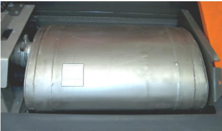
Der Dieselpartikelfilter (DPF) ist im Originalschalldämpfer integriert. Alle vorhandenen Anschlüsse bleiben im Originalzustand erhalten.
