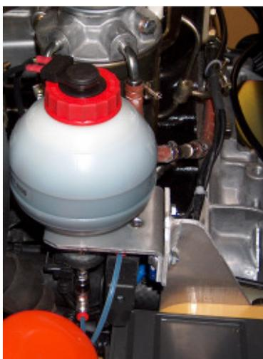
Das Steuergerät wird mittels Klettband neben den Kühlflüssigkeitsbehälter angebracht.
