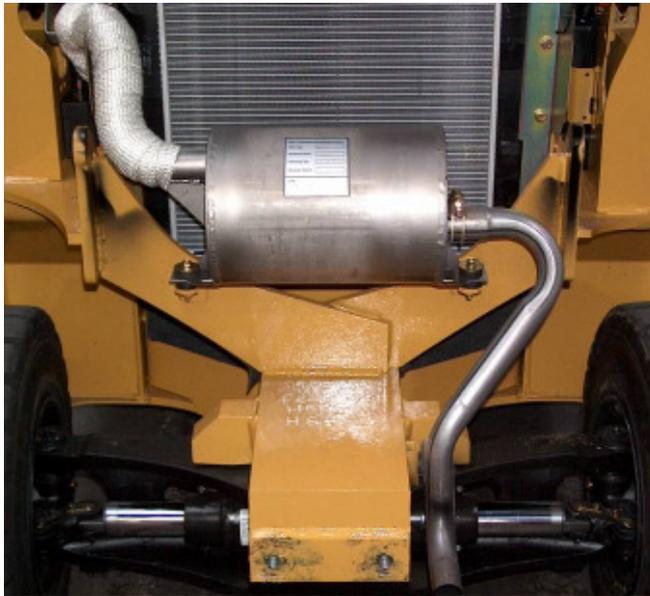
Der Dieselpartikelfilter ist im Original-Schalldämpfer integriert. Dadurch kann man den Filter mit den vorhandenen Schrauben montieren.
