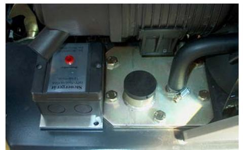
Der DPF wurde dem Original-Schalldämpfer nachgebaut. Damit können alle Original-Halterungen bzw. Schrauben zur Befestigung des DPF beibehalten werden
