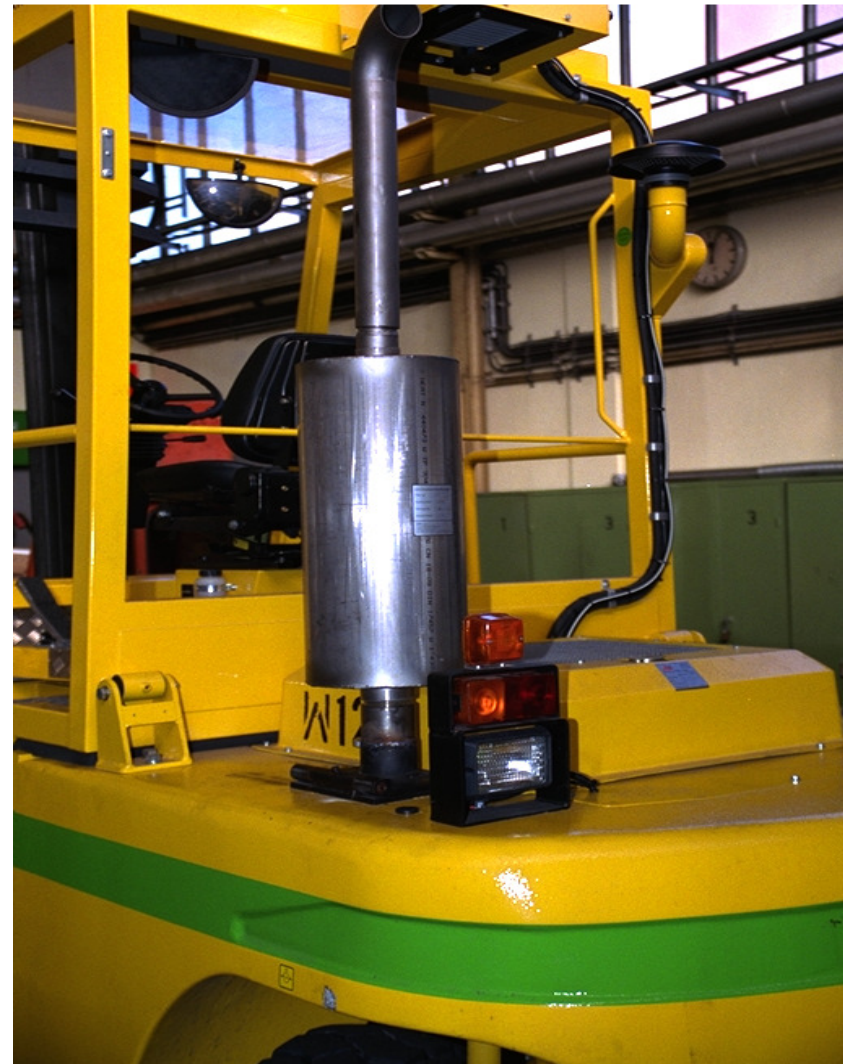
DanTruck mit GfA-Dieselpartikelfiltersystem
