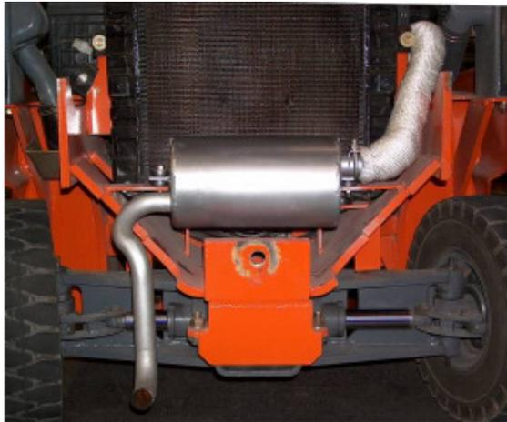
Der Dieselpartikelfilter ist im Original-Schalldämpfer integriert und kann somit mit den Original-Anschlüssen des Abgasinrittsrohrs verschraubt werden. Das Eingangsrohr vom Krümmer bis hin zum Filtereintritt muss gut isoliert werden.
