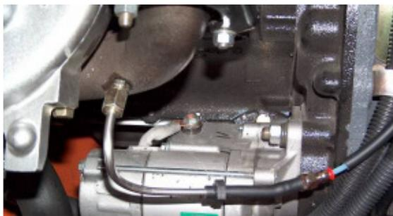
Für das Abgasgedruckerührchen ein 1/8“-Gewinde in das Eingangsrohr zum Filter hin geschnitten werden.
