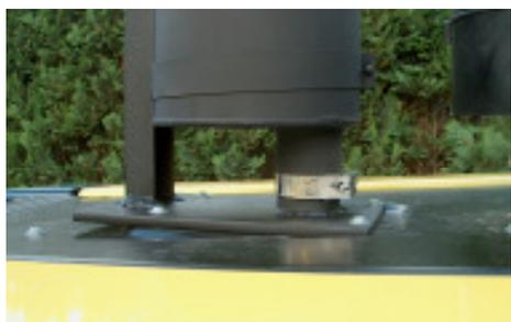
Das Rückschlagventil kommt in die Kraftstoffleitung vor den Kraftstofffilter. Von hier aus führt ein Teflonschlauch zum 2,5 Liter Dosierbehälter.
