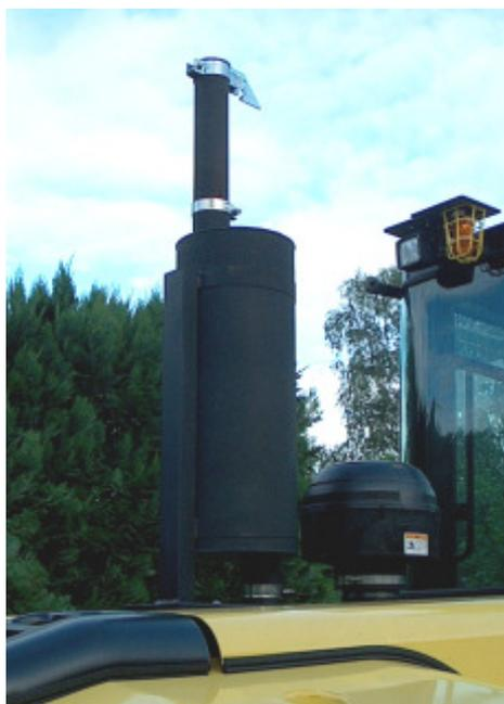
Anstelle des Original-Schalldämpfers wird das DPF-System mit Hilfe einer speziellen Halteplatte stehend montiert.
