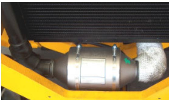
Die Verrohrung vom Abgaskrümmter zum Filter ist bereits vorisoliert. Am Winkel ist der Abgriff für den Abgasgegendruck.
