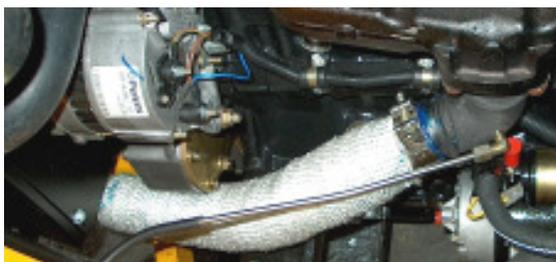
Das Additiv wird durch einen 4mm Teflonschlauch über ein Rückschlagventil in den Kraftstofffilter geführt.
