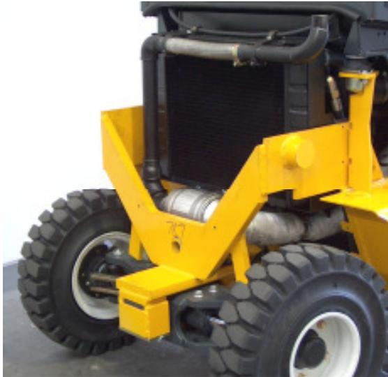
Anstelle des Original-Schalldämpfers wird der DPF (Dieselpartikelfilter), durch einen im Lieferumfang enthaltenen Halter mit zwei Schellen, an vorhandene Gewindebohrungen befestigt.
