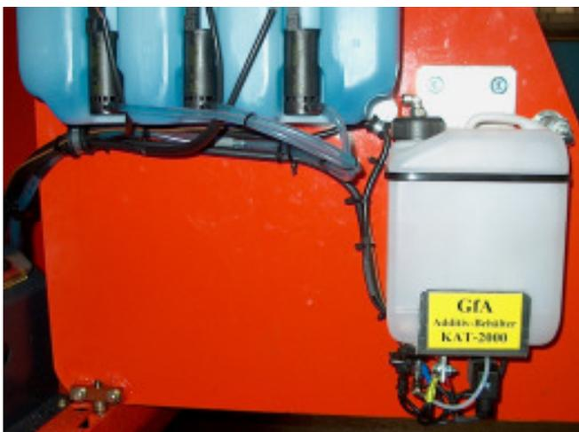
Die Dosiereinrichtung mit dem 2,5 Liter Behälter wird an der Revisionsklappe befestigt.
