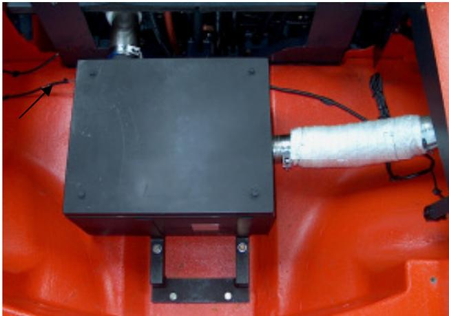
Der Filter wird darauf montiert und mit entsprechenden Schellen am Eingangs- und Ausgangsrohr befestigt.
