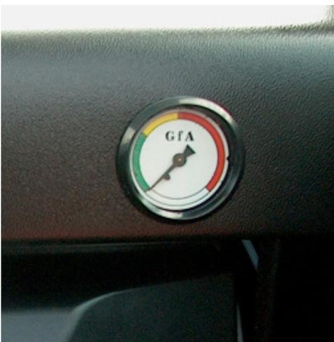
Der Druckmanometer wird im Führerhaus in der Verkleidung integriert.
