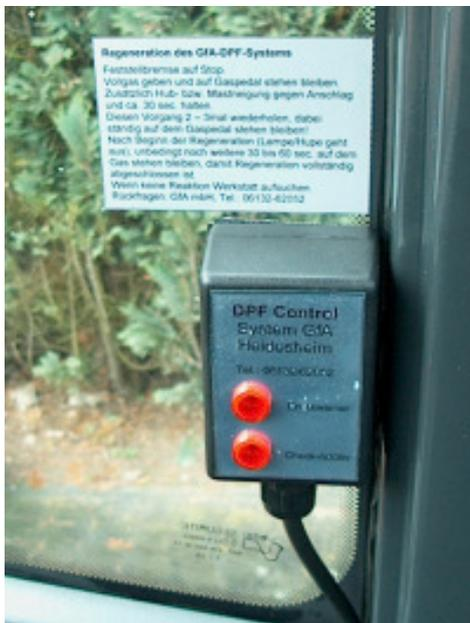
Die Drucküberwachungseinheit (DPF-Control) wird gut sichtbar im Führerhaus montiert.
