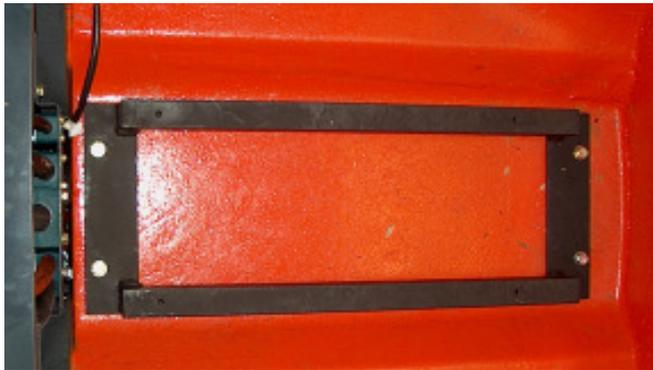
Zum Einbau des Filters wird der Original-Schalldämpfer ausgebaut.
