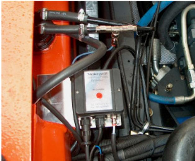
Das Steuergerät für die Dosiereinrichtung wird mittels einer speziellen Halteplatte im Motorraum befestigt.
