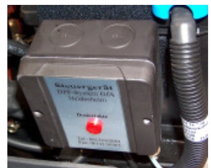
Abb. Rechts: Das Steuergerät wird mittels Klettband im Motorraum angebracht.
