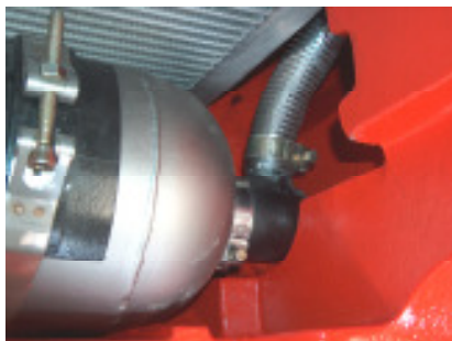
Abb. Links: Spezialhalterung zur Auflage des DPF's unter Verwendung der vorhandenen Halterung des Original-Schalldämpfers.
