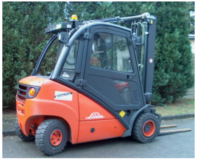
Foto links und oben zeigen den 393 mit eingebautem DPF (Dieselpartikelfilter) von der Seite und von hinten.
