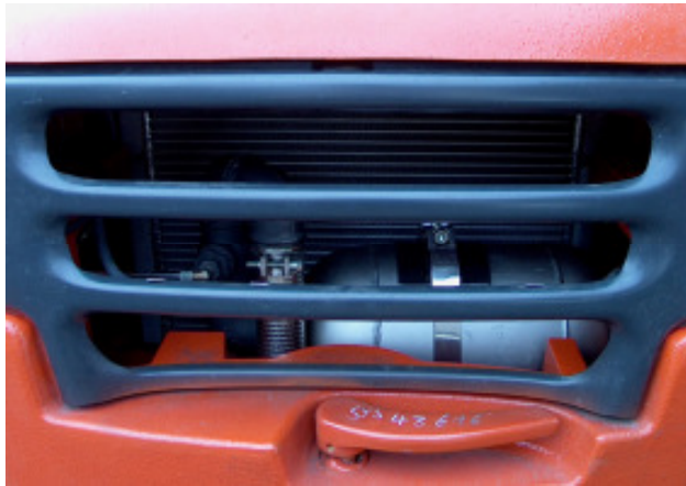
Foto links und oben zeigen den 393 mit eingebautem DPF (Dieselpartikelfilter) von der Seite und von hinten.
