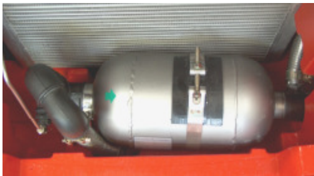
Abb. Links: Spezialhalterung zur Auflage des DPF's unter Verwendung der vorhandenen Halterung des Original-Schalldämpfers.
