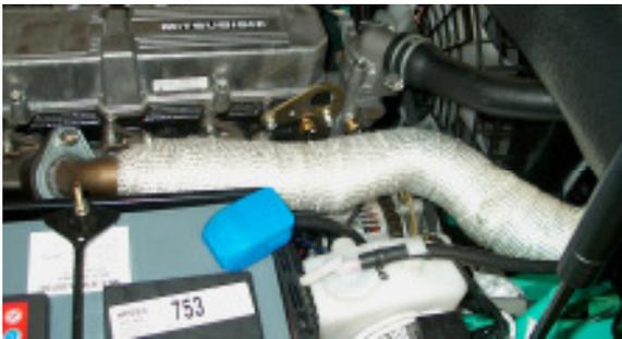
Zum Montieren des Abgasgedrucktöhrchens muss ein 1/8 Zoll-Gewinde in den Krümmer geschnitten werden.
