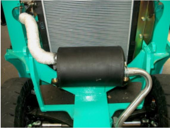
Der Dieselpartikelfilter ist im Original-Schalldämpfer integriert. Dadurch kann man den Filter mit den vorhandenen Schrauben montieren.
