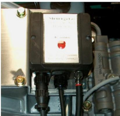
Die Dosiereinrichtung und das Steuergerät werden mittels einer Halterung im Motorraum montiert.
