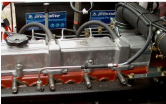
Das Abgasgedrueckröhrchen ist am Krümmerrohr durch eine 1/8" Gewindebohrung angeschraubt.
