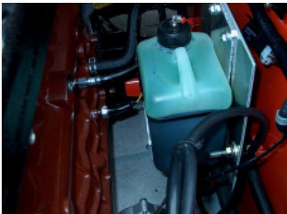
Dosiereinrichtung 2,5 Liter Behälter wird mittels einer Halteplatte im Motorraum angebracht.
