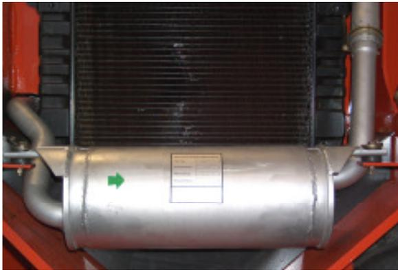
Der Dieselpartikelfilter ist im Original-Schalldämpfer integriert und kann mit den Original-Anschlüssen des Abgas-Eintrittsrohrs und Abgas-Austrittsrohrs verschraubt werden.
