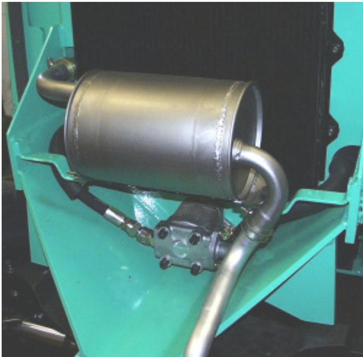
Ein, im Lieferumfang enthaltenes, Abgasgedrueckröhrchen wird auf ein vorgebohrtes 18mm Loch an das Krümmerrohr geschweißt.
