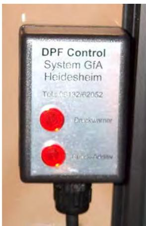
Die DPF-Control wird gut sichtbar im Führerhaus angebracht.
