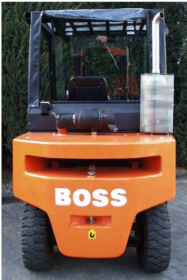
GfA-Dieselpartikelfiltersystem aufgebaut auf Kontergewicht. Der Originalschalldämpfer wird durch das GfA-System ersetzt. Die Original-Schrauben können zur Befestigung des Filters benutzt werden.
