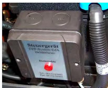
Das Steuergerät wird im Motorraum montiert.
