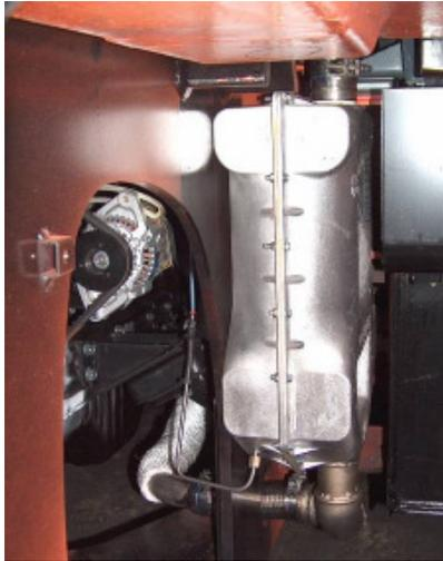
Der DPF wird anstelle des Original-Schalldämpfers montiert. Zur Befestigung bedarf es zweier Ø 9mm Bohrungen, durch die seitliche Platte des Fahrgestells, positioniert nach den beiden Innengewinden im Alu-Gehäuse des DPF's. Anschließend kann der DPF mit diesen beiden Schrauben M8 befestigt werden.
