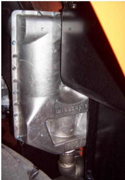
Abgas-Eingang/Ausgang werden mit zwei beigelegten Flexschläuchen verbunden. Das Abgasrohr vom Krümmer bis vor den DPF wird mit beigelegtem Isomaterial gut isoliert.
